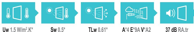
\*(avec un double vitrage 28 mm - Ug = 1,1 W/m².K avec intercalaire isolant)
