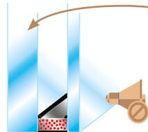
Des épaisseurs de vitrage augmentées permettent de mieux filtrer les ondes sonores, garantissant un meilleur confort acoustique.
