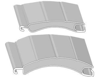
41 mm de largeur et de 8,5 mm d'épaisseur ou de 52 mm de largeur et de 13 mm d'épaisseur. Lame isolée et composée d'un feuillard aluminium, remplie de mousse isolante haute densité, elle est proposée en différents coloris.
