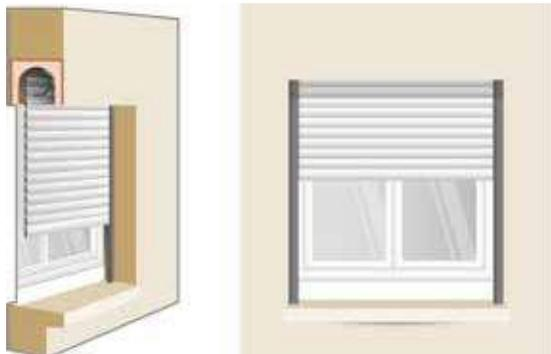
Pose en neuf dans un coffre tunnel
